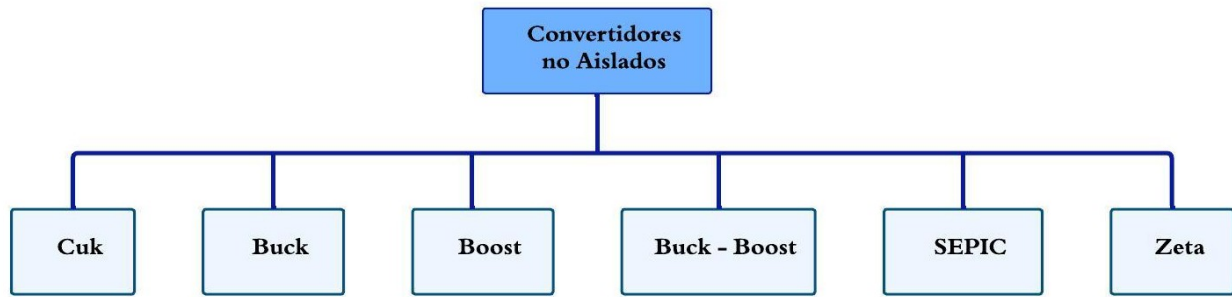
Figura 2.10 Convertidores multipuerto no aislados.
