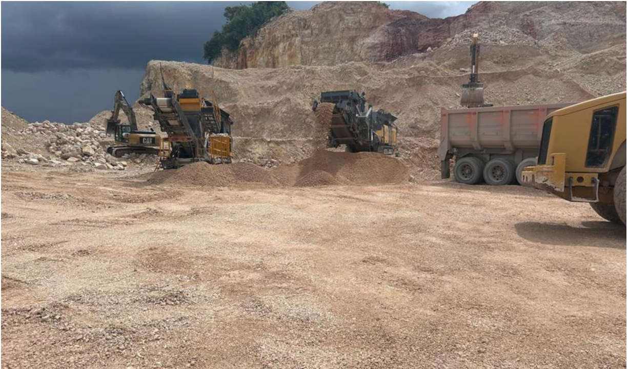
Imagen 45. Producción de sub-balasto
