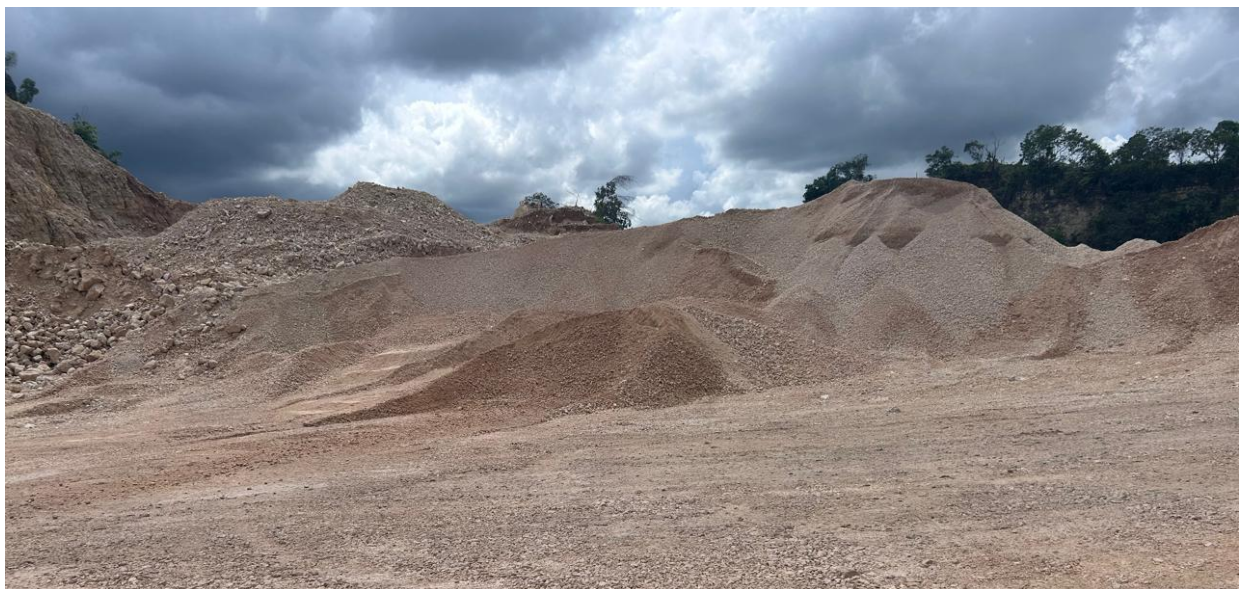
Imagen 46. Almacén de sub-balasto
