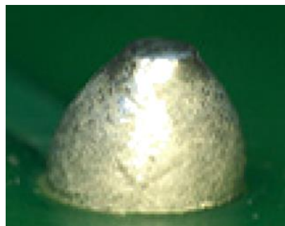
Imagen 5.22 Unión fría en soldadura
