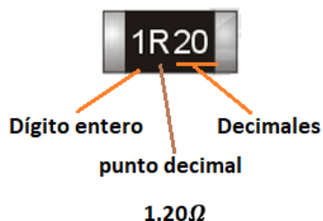
Imagen 3.9 Ejemplo 1 de código de resistencias SMD 4 dígitos menor a 100\Omega
