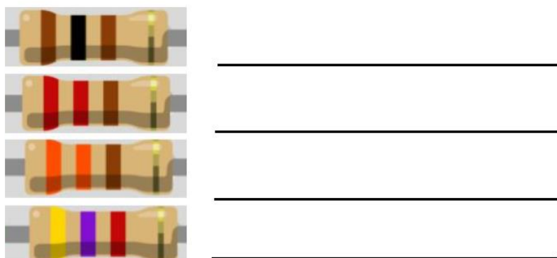
Imagen 2.66 Ejercicio de valores de resistencias por código de colores
