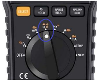
Imagen 3.67 Selección de prueba de diodos
