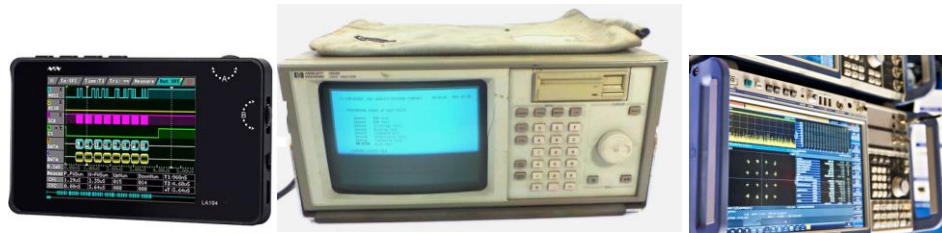
Imagen 4.1 Analizadores de señales digitales
