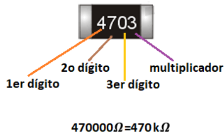
Imagen 3.8 Código de resistencias SMD 4 dígitos mayor a 100\Omega
