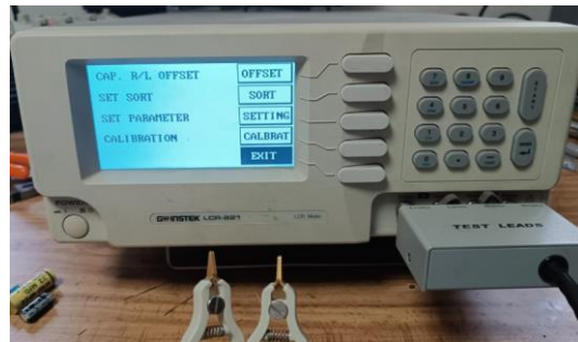
Imagen 3.21 conexión y corrección de sondas
