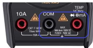
Imagen 3.66 Conexión de puntas de multímetro
