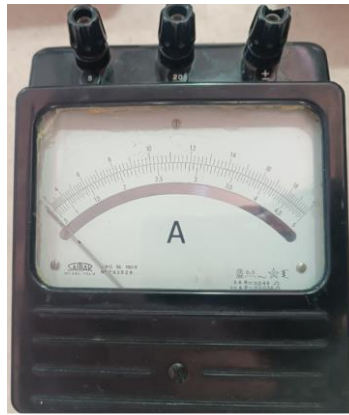
Imagen 2.11 Amperímetro analógico de c.a
