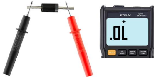
Imagen 3.62 Prueba correcta de diodo en inversa
