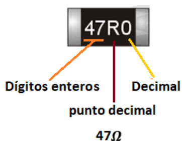
Imagen 3.10 Ejemplo 2 de código de resistencias SMD 4 dígitos menor a 100\Omega
