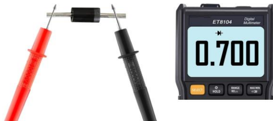
Imagen 3.61 Prueba correcta de diodo en directa
