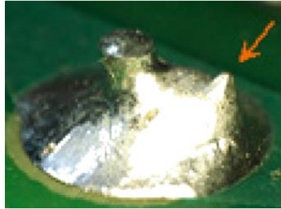
Imagen 5.19 Proyección de soldadura
