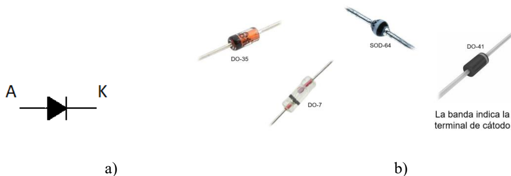
Imagen 3.55 a) símbolo del diodo b) Diferentes encapsulados del diodo
