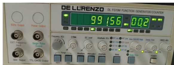
Imagen 2.48 Generador de señales
