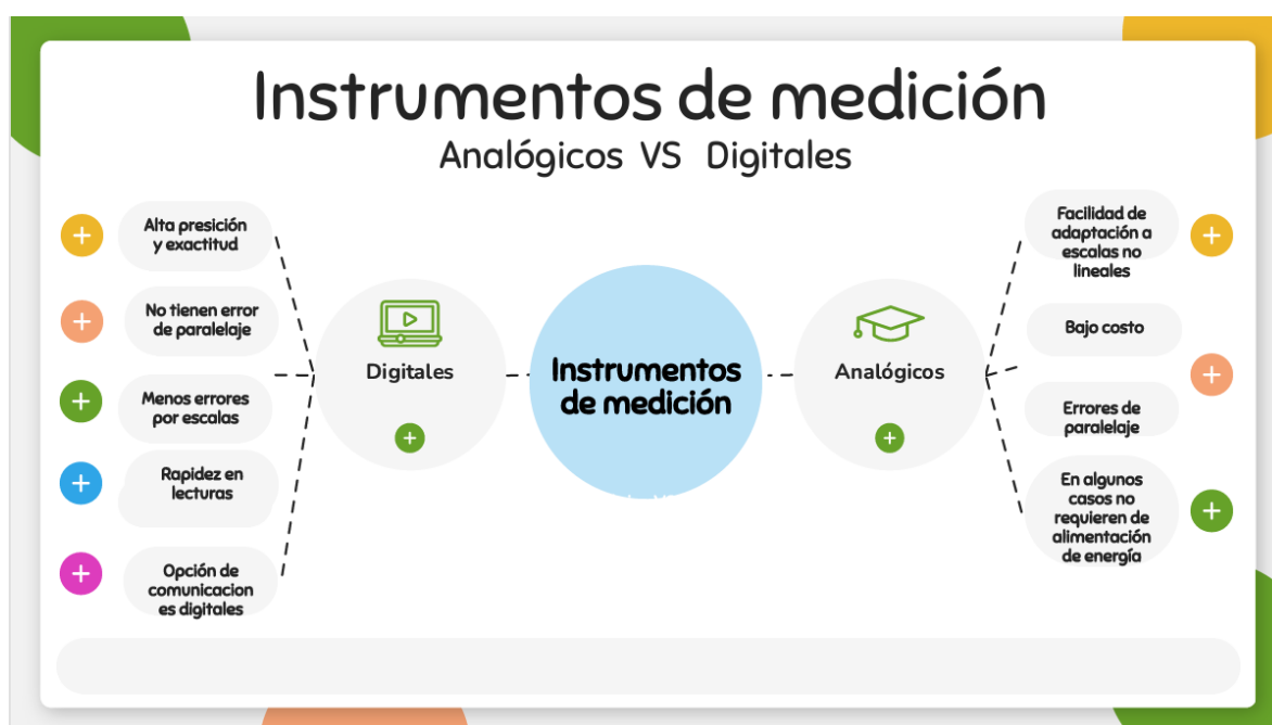
Imagen 2.3 Comparación de medidores digitales y analógicos
