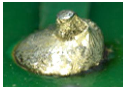
Imagen 5.21 Sobrecalementamiento de soldadura. Exceso de temperatura
