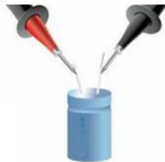
Imagen 3.38 medición de capacitancia
