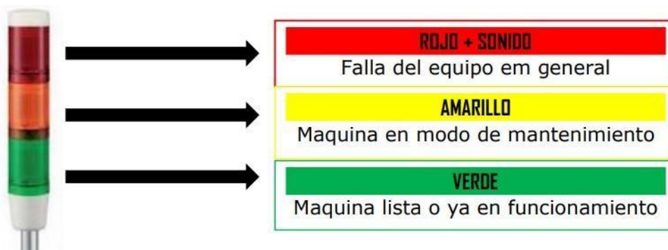
Ilustración 24 Simbología de la torreta de seguridad
