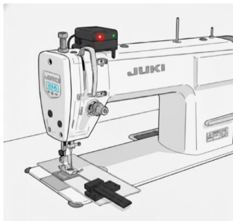
Figura 2. Indicación de falla en el proceso de costura
