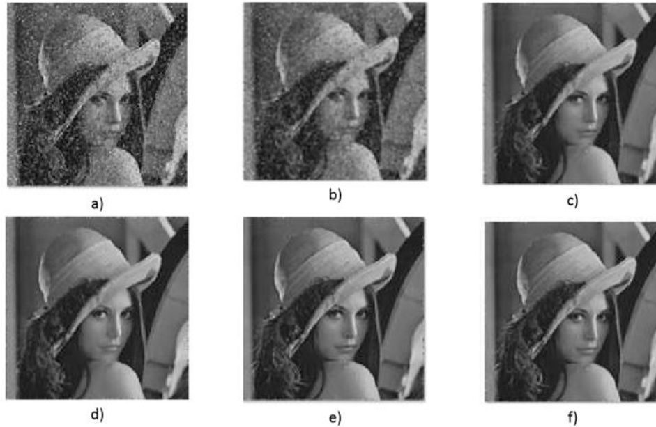
Figura 2.3 a) Imagen con ruido 10%, filtrada con b) filtro promedio, c) filtro de mediana, d) filtro morfológico, e) filtro con SCM, f) filtro con ICM [Ortiz, 2017]
