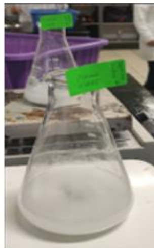
Primera agitación con 2.6 gr de cáscara de huevo limpio
