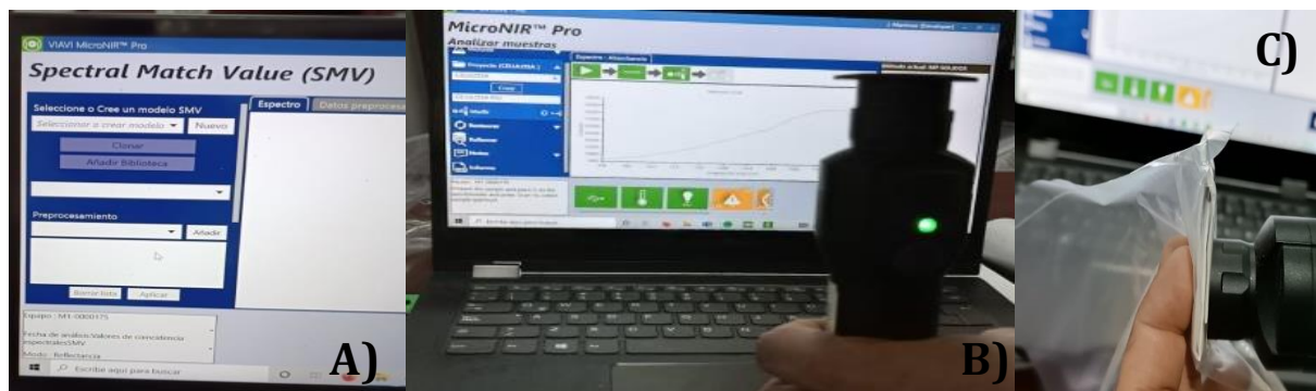
Ilustración 33. Introducción de base de datos A) Programa correspondiente para equipo MicroNIR; B) Lectura blanco de referencia; C) Lectura muestra base. Fuente: El autor.
