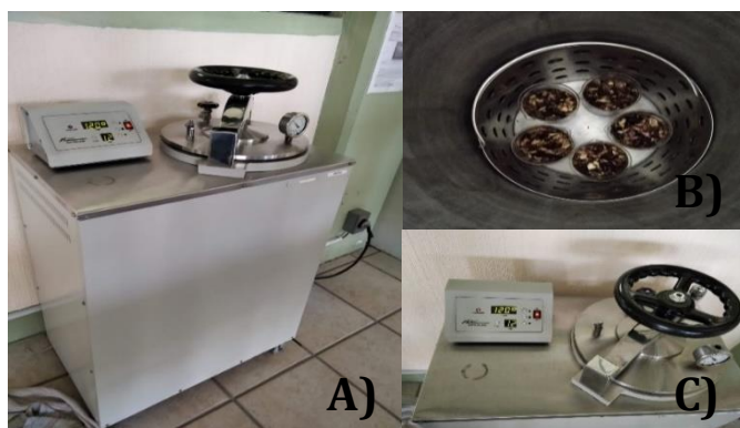
Ilustración 17. A) Autoclave con parámetros de cocción; B) Introducción de muestras en autoclave; C) Cocción en autoclave. Fuente: El autor.
