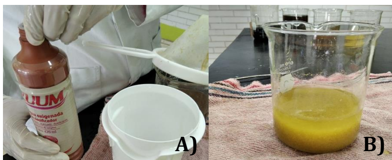
Ilustración 20. A) Blanqueado con Peróxido de hidrogeno; B) Muestra resultante. Fuente: El autor.
