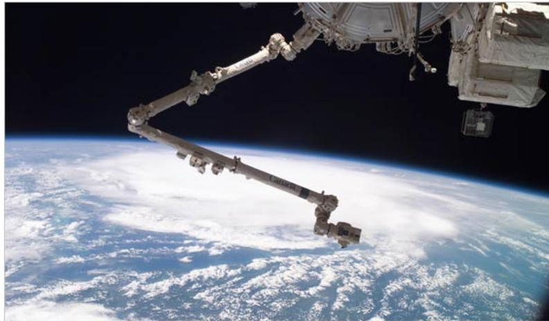
Fig. 3.3. Manipulador remoto de la estación espacial (SRMS).
