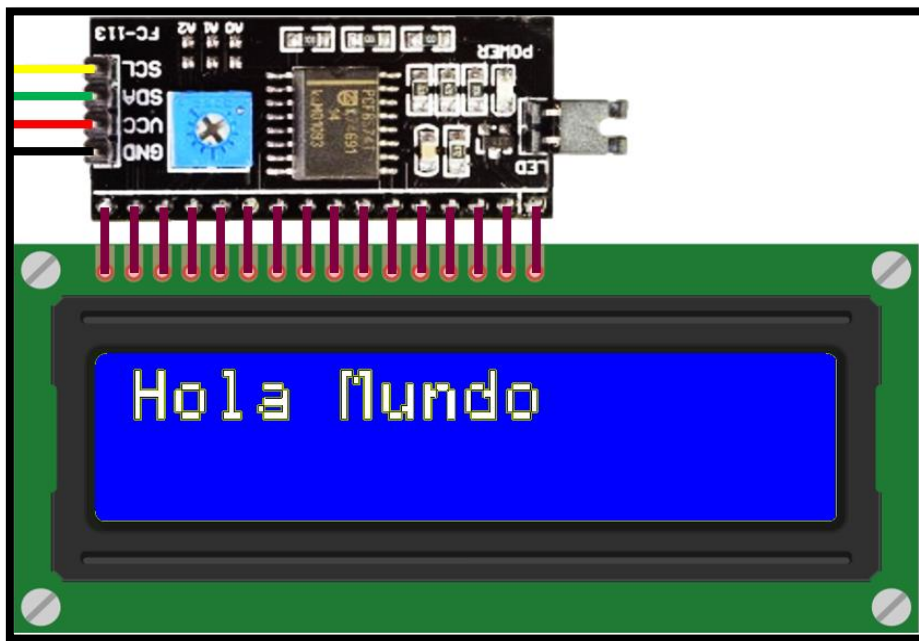
Figura 0.10 Conexión del módulo I2C con la pantalla LCD. "Elaboración propia".
