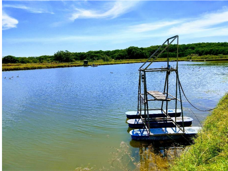
Figura 40. Fotografía del módulo de medición montado en una boya
