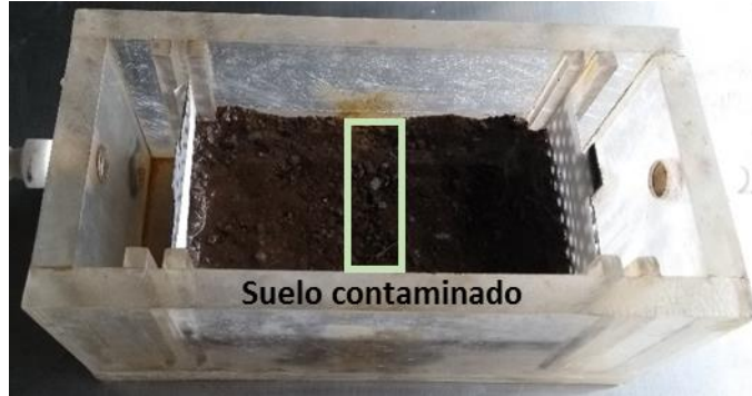
Figura 4.4. Arreglo de la celda con sustrato contaminado.
