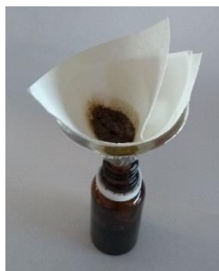
Figura 4.7. Lavado de sustrato para extraer los hidrocarburos.
