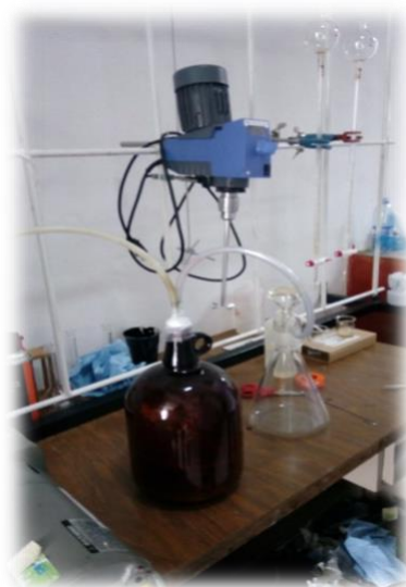
Figura 4.7. Preparación del rack con bomba de vacío para obtención de la fracción inorgánica.
