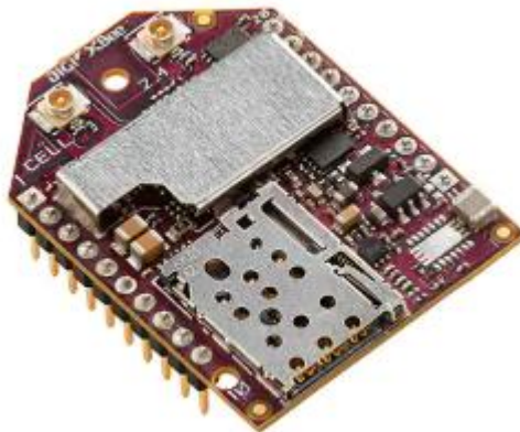
Ilustración 2.8 XBEE Celular Modelo XB3-C-A2-UT-001
