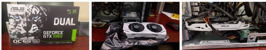
Figura 4.1: Instalando la tarjeta de video
