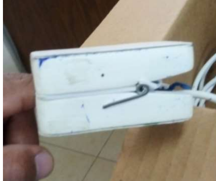
Figura 5.8. Armado del sensor Infrarrojo.
