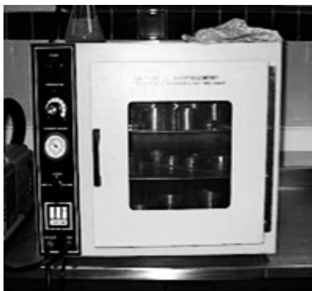
Figura 16 Estufa al vacío del Laboratorio de Ingeniería
