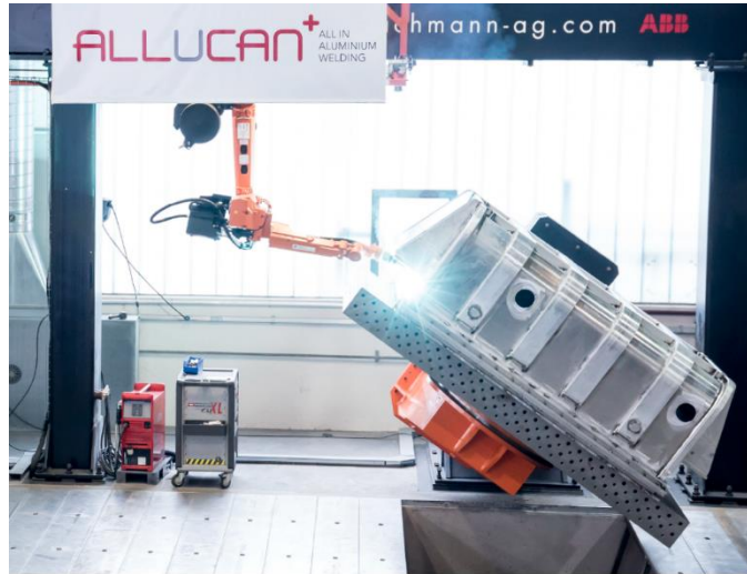
Figura 1.1 Robot industrial de soldadura ejecutando una tarea en cooperación con un dispositivo posicionador de 2 grados de libertad. Cortesía de ABB.
