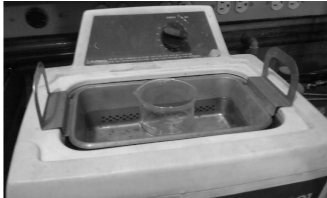
Figura 2.1.- Imagen del vaso de precipitado con las muestras de sustratos en la tina de baño ultrasónico.
