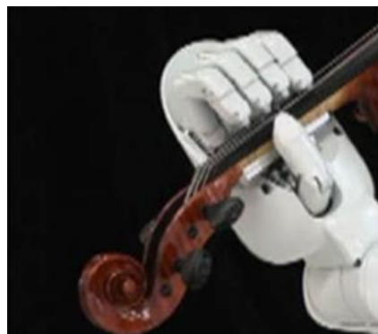
Figura 1.6. Detalle de la mano izquierda del robot violinista de Toyota [3].
