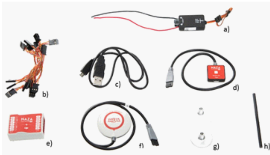
Figura 2.27: Componentes de DJ NAZA a) BEC; b) conexiones; c) cable USB; d) LED indicador; e) tarjeta principal; f) GPS NAZA; g) base GPS; h) extensor GPS. (Fuente: Elaboración propia)
