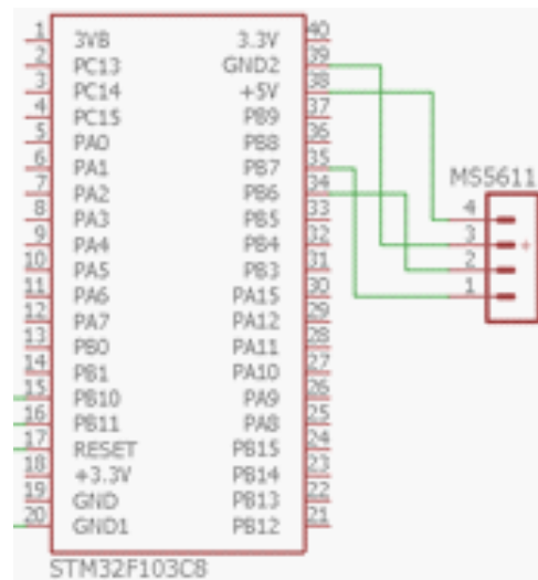
Figura 3.20: STM32F103C Conexiones barómetro. (Fuente: Elaboración propia)
