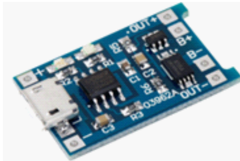
Figura 3.32: Chip de protección de batería DW01. (Fuente: Elaboración propia)
