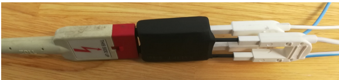
Figura 20 Modulo diseñado para conexión de Phase 3 y divisor de voltaje.
