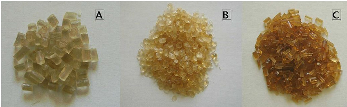
Figura 9. El almidón plastificado con glicerina producida bajo tres condiciones de extrusión diferentes (Bajer, 2013).
