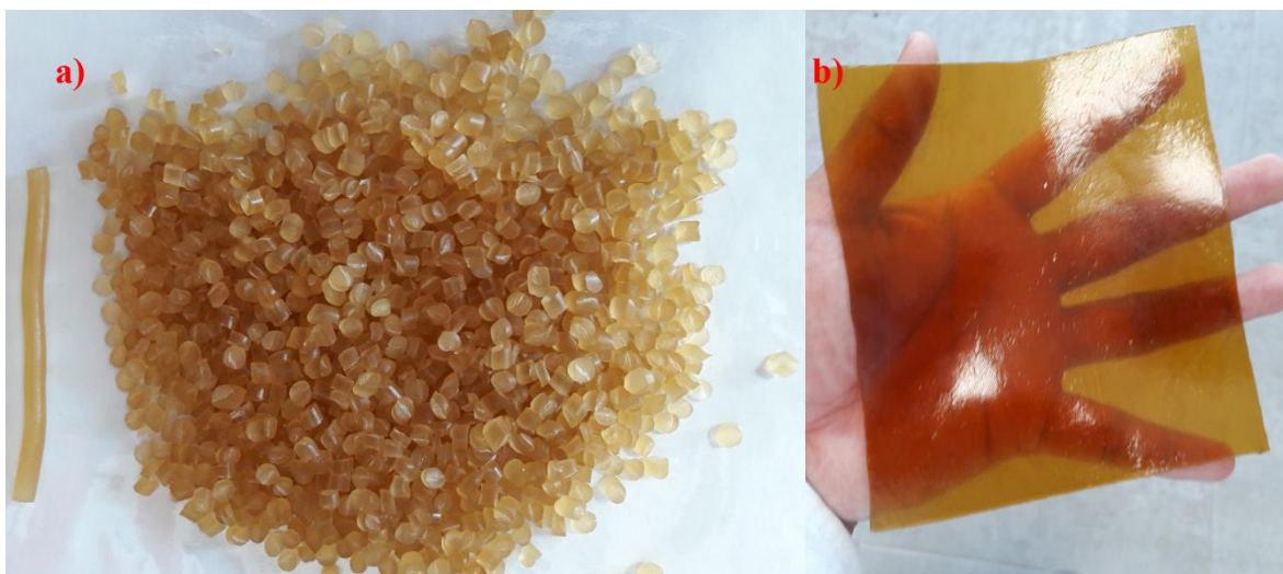
Figura 19. a) Pellets obtenido por extrusión y b) película obtenido por moldeo por compresión de almidón termoplástico de Pich (T4).
