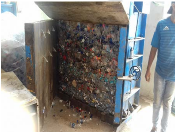
Figura 4.10 Área de prensado de residuos plásticos en la planta de tratamiento de SMEC, año 2017 (fotografía cortesía de A. Salazar).
