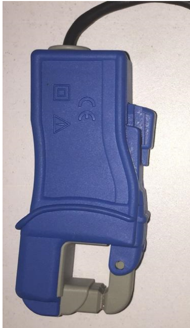
Fig. 6.5. Sensor de corriente con núcleo de material ferromagnético.
