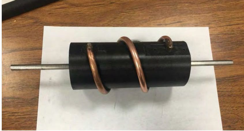
Figura 5-8. Prototipo físico del inersor confluido MR.
