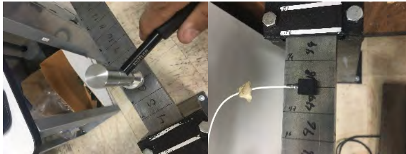
Discretización y análisis con el martillo de impacto.
