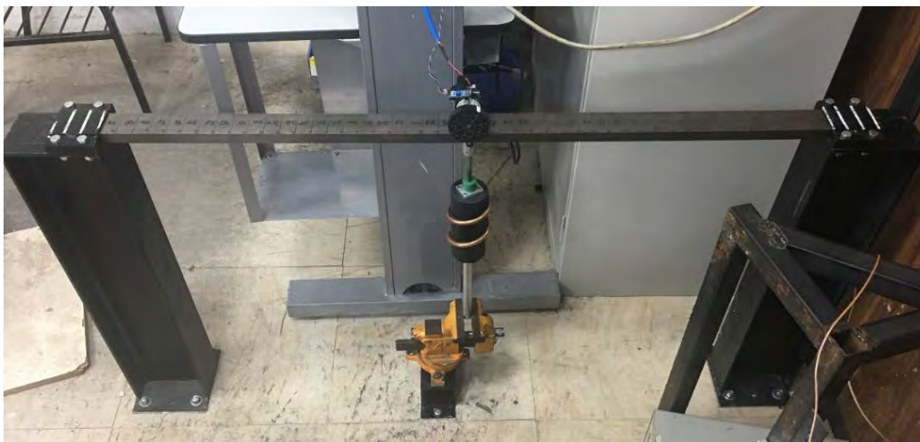
Figura 5-26. Configuración del banco experimental con el inersor como amortiguador reológico.
