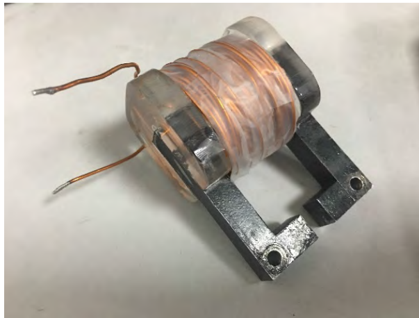
Figura 5-9. Válvula MR adaptable al inersor con fluido.
