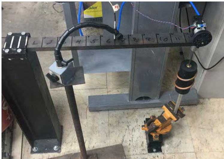
Figura 5-29. Configuración de viga en cantiléver del banco experimental.
