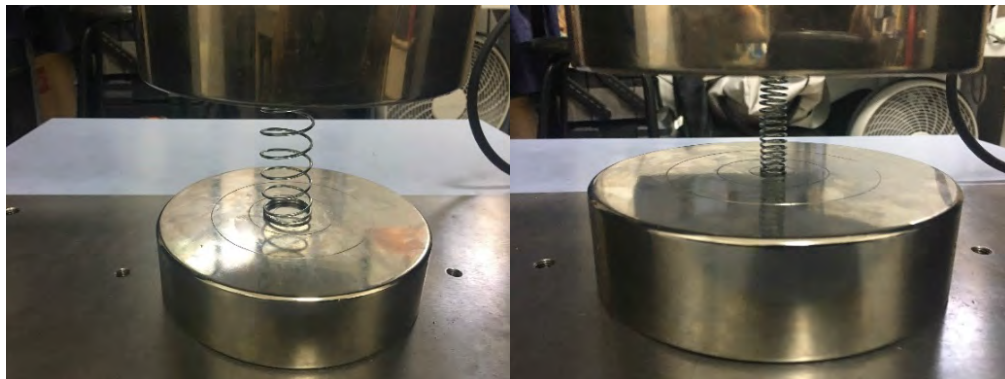
Figura 5-10. Análisis de rigidez de los resortes 028 y 038 respectivamente.
