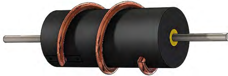
Figura 5-3. Esquema del prototipo del inersor con fluido MR.
