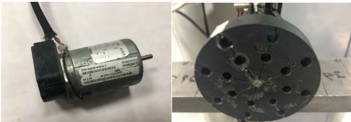
Figura 5-13. Motor y disco utilizados para inducir una fuerza de excitación inercial al sistema.
