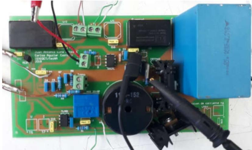
Figura 3.12. Implementación del convertidor Boost.
