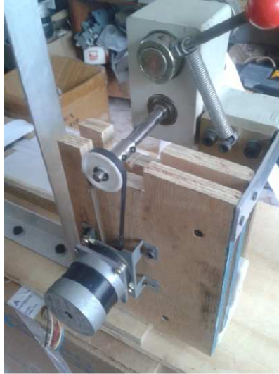
Figura 3.5 Sistema de tracción con motor a pasos.
