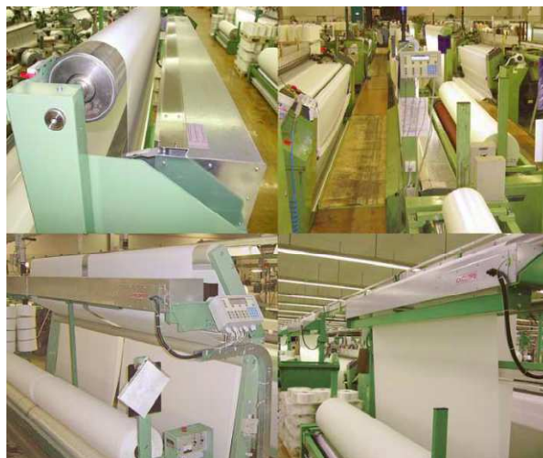
Figura 1.4 Máquina industrial de inspección automática de Telar [5].
