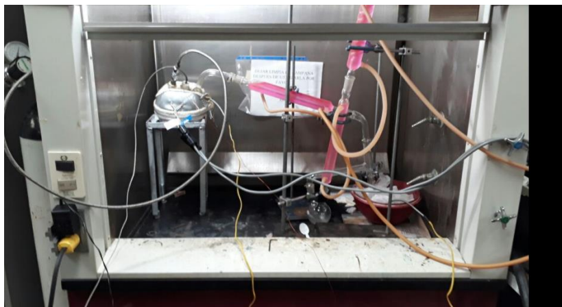
FIGURA 4.2. Montaje de proceso de pirólisis
