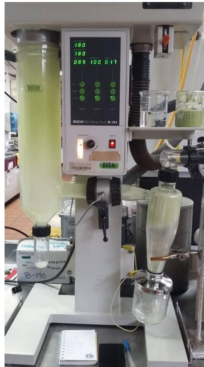
Figura 4.2 Secador por aspersión BÜCHI mini spray dryer B-191.
