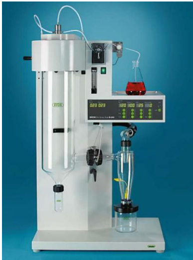
Figura 4.1 Secador por aspersión BÜCHI mini spray dryer B-290.
