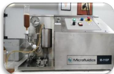
**FIGURA 5.5. Homogeneizador por microfluidización**
