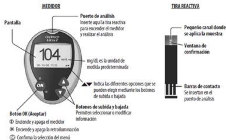
Figura 5.- Principales características del glucómetro OneTouch Ultra2 (OneTouch, 2010).
