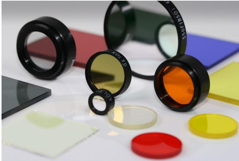
Figura 2.11: Ejemplos de Filtros Polarizados.
