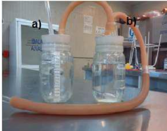
Figura 2.9 Sistema de medición de biogás a) frasco graduado y b) frasco con solución de NaCl
