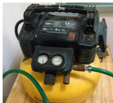
Figura 2.14 Compresor de aire para prueba de fugas
