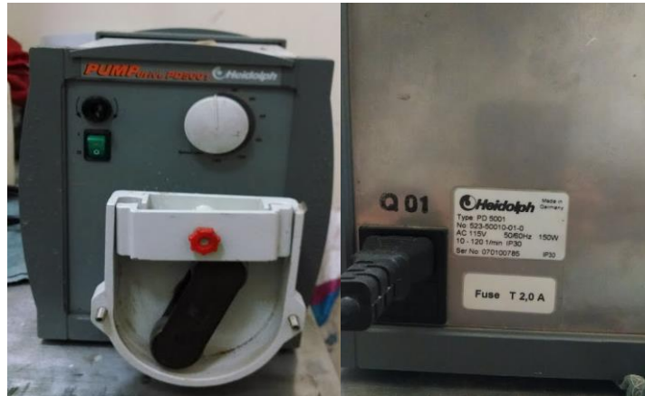
Figura 2.17 Bomba peristáltica de recirculación de lodos.
