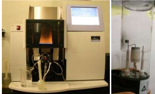
Figura 2.36 Espectrofotómetro de absorción atómica y lámpara de cátodo hueco para la determinación de cationes solubles en el lodo de potabilización.
