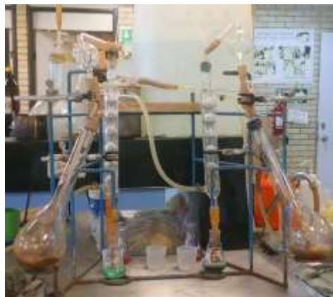
Figura 2.37 Determinación de nitrógeno total en el lodo al 100% y tratamientos del 0 al 40%
