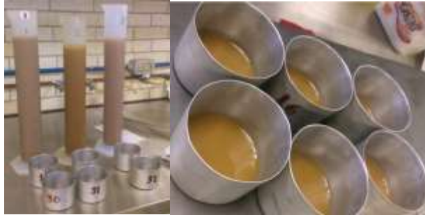
Figura 2.38 Determinación de textura mediante el método de la pipeta en el lodo al 100% y tratamientos del 0 al 40%
