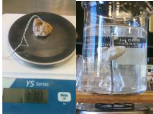
Figura 2.31 Determinación de densidad aparente del lodo de potabilización.
