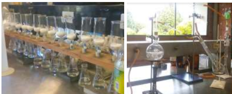
Figura 2.34 Determinación de la capacidad de intercambio catiónico en el lodo de potabilización.
