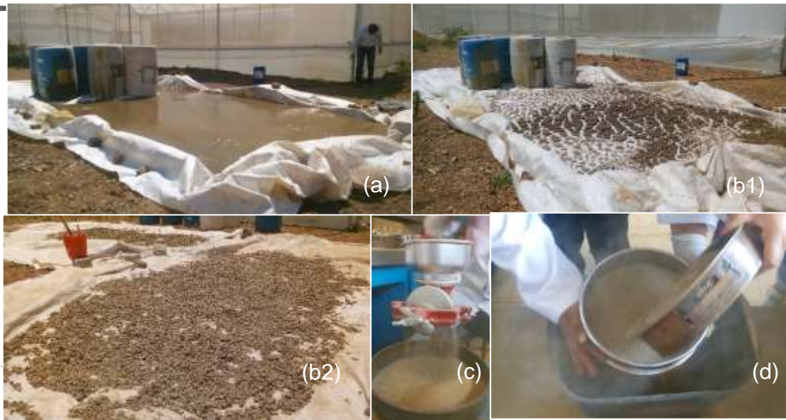
Figura 2. 22 Extendido del lodo (a), secado (b1) (b2), molienda (c) y tamizado (d)
