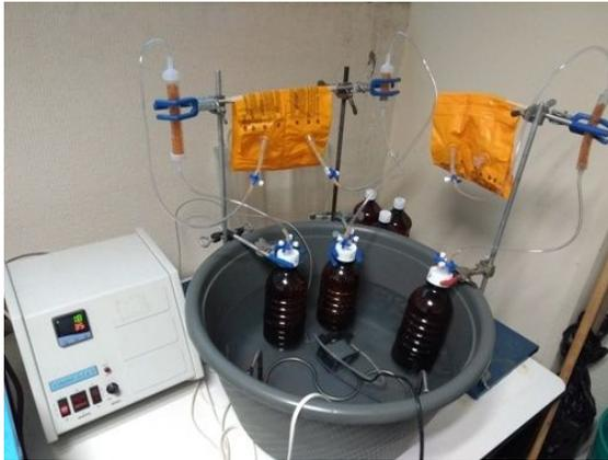
Figura 4.33. Sistema de generación y captación de biogás utilizado en los experimentos
