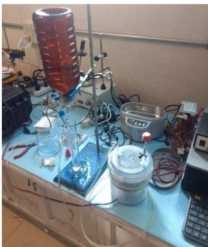
Figura 4.27. Sistema de extracción de gases con ultrasonido
