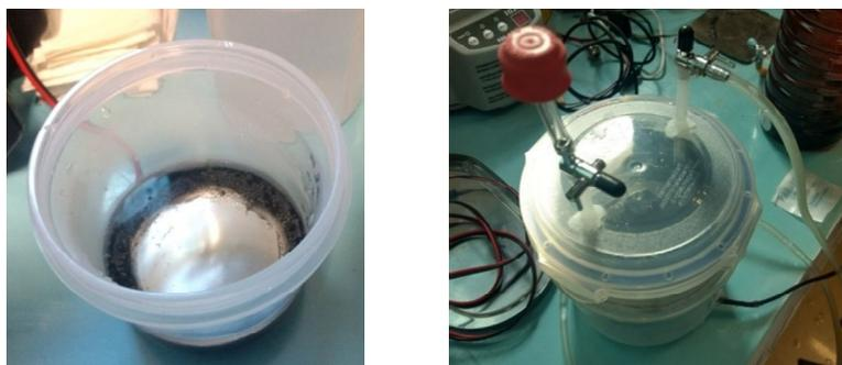
Figura 4.26. Recipiente de extracción de gases.
