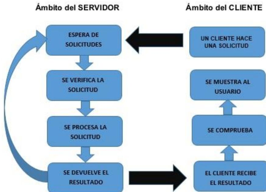
Figura 4-4. Funcionamiento de la arquitectura CLIENTE – SERVIDOR
