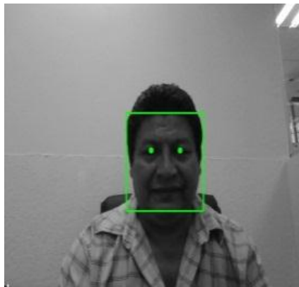
Figura 4.6. Imagen después de aplicar la técnica de ASEF para la detección de los ojos.
