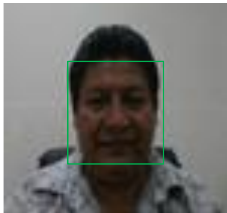
Figura 4.5 Detección del rostro aplicando el concepto de imagen integral y clasificadores en cascada (algoritmo de Viola & Jones).
