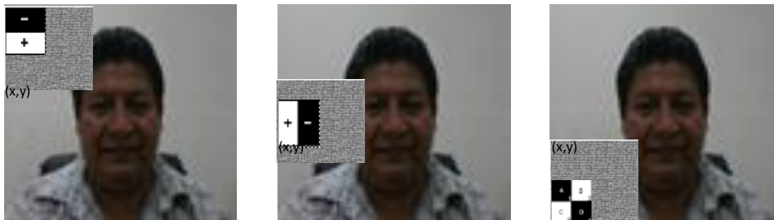
Figura 4.4. Convolución de filtros para la detección del rostro.
