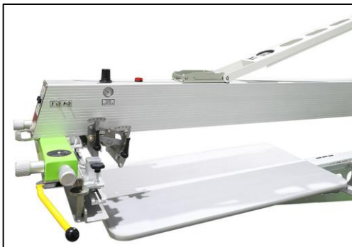
Figura 17 Paletas de máquina serigráfica
