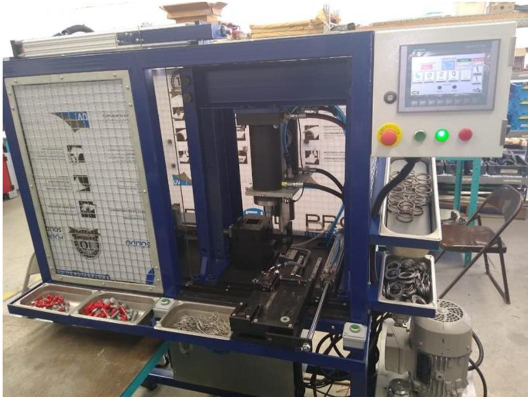
Imagen 4.1.4 Estación de ensamble finalizada con implementación de programación KOP para el controlador lógico programable Siemens Simatic S7-1200 CPU 1214C DC/DC/DC e interfaz hacia la pantalla táctil Siemens Simatic KTP700 Basic.
