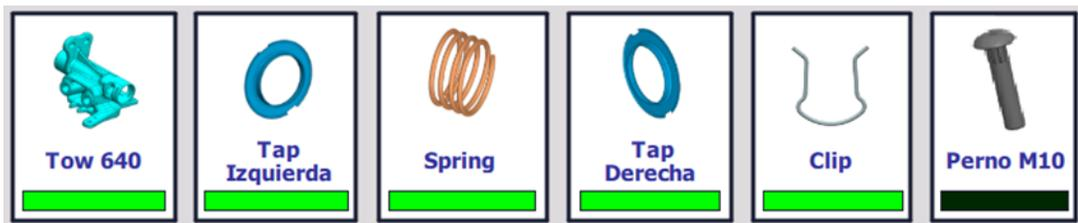
Imagen 3.7.1.5.1 Panel de componentes que informa de un perno M10 ausente o mal colocado. Esto debido a que el sensor inductivo correspondiente a la entrada digital I8.3 ("Pz\_M10Izq") no detecta ningún objeto metálico y la apariencia del recuadro correspondiente no se modifica de color oscuro RGB [0; 40; 0] a verde RGB [0; 255; 0].
