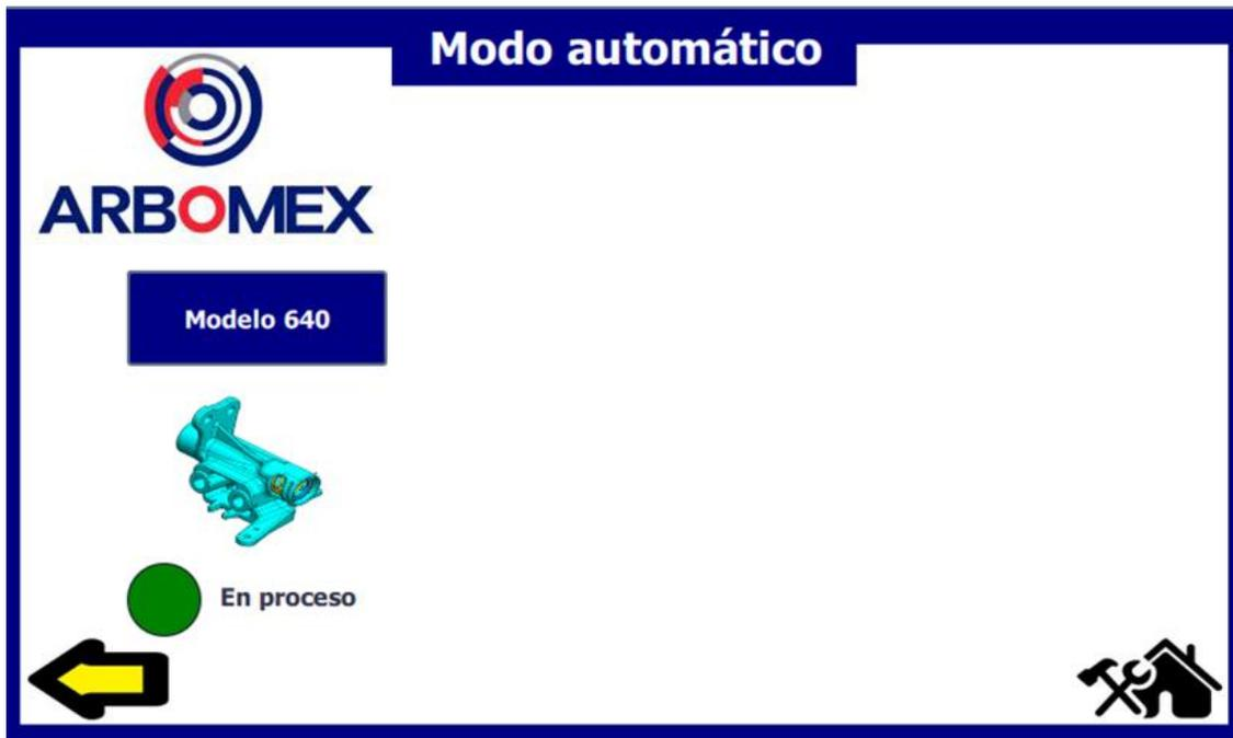
Imagen 3.7.1.2. Imagen "A003\_Auto" al estar activado el proceso de ensamblado automático del modelo 640 desaparecen los botones de acceso a los modelos 641 y 642. Además de que un círculo parpadea en color gris RGB [222; 219; 222] a verde RGB [0; 130; 0] para indicar que el sistema está trabajando en el modelo correspondiente.
