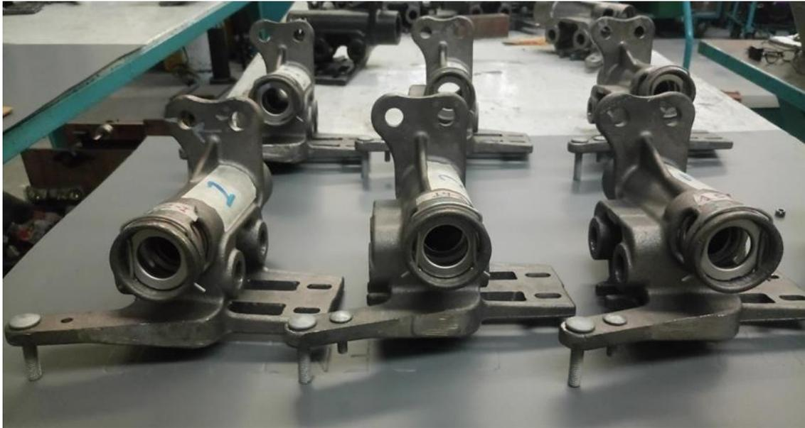
Imagen 4.1.6 Piezas ensambladas con el proceso automático. La pieza de la izquierda frontal corresponde al modelo 640 mientras que la pieza central frontal y derecha frontal corresponden al modelo 642.
