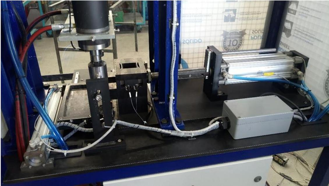
Imagen 4.3.2 Cableados eléctricos, neumáticos e hidráulicos en el interior de la estación de ensamble.
