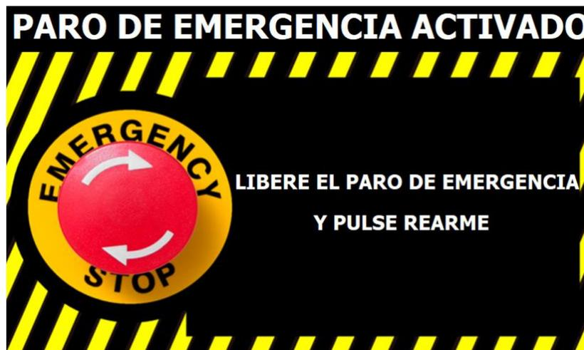
Imagen 3.7.6.1 Pantalla de bloqueo destinada al paro de emergencia. Incluye un texto descriptivo sobre el método a seguir para continuar con la operación.
