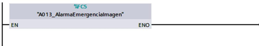
Imagen 3.6.3 Función para colocar pantalla de bloqueo al ser activador el botón de paro de emergencia
