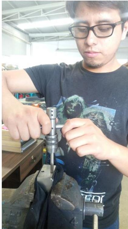
Imagen 3.9.1 Apoyo técnico en la elaboración de un machuelo sobre un barreno con herramienta machuelo M10 x 1.0 en la pieza de soporte que conforma parte del nido de la estación de ensamble.
