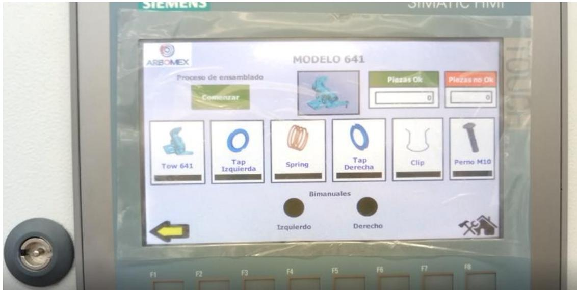
Imagen 4.1.2.1 Implementación de interfaz HMI mostrando a la imagen "B002\_Mod641" procedente del modo automático para en ensamble del modelo 641.
