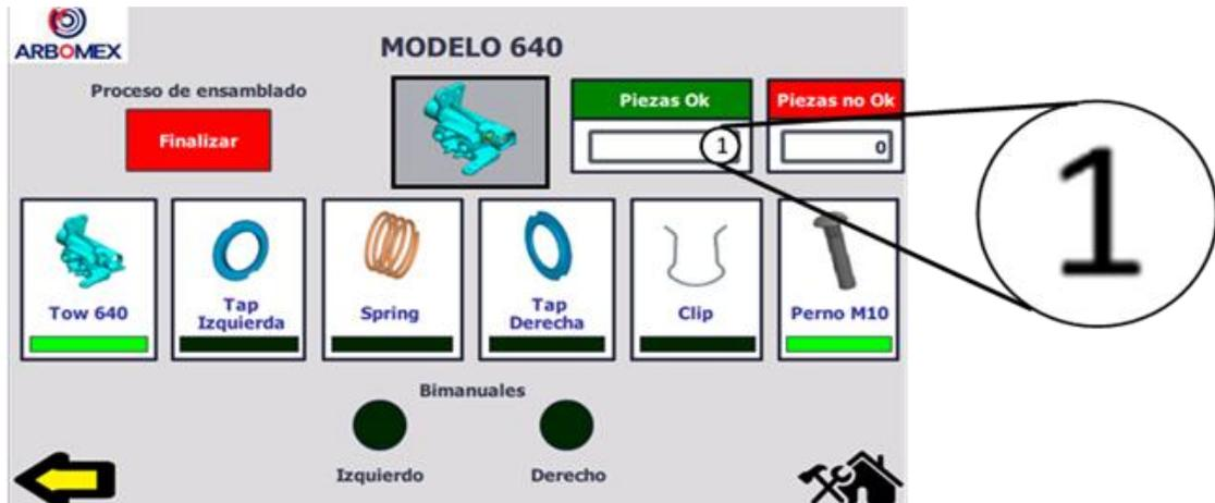
Imagen 3.7.1.4.2 Conteo realizado a piezas ensambladas correctamente. En este ejemplo el proceso ha ensamblado una pieza.
