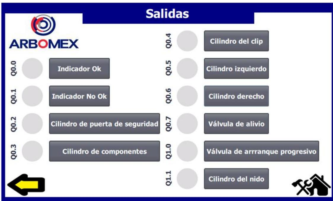
Imagen 3.7.3.5 Imagen "C003\_Output" correspondiente al forzado de señales de salida dentro del modo mantenimiento
