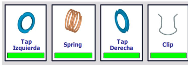
Imagen 3.7.1.5 De igual manera en imagen “B001\_Mod640” el color verde en la barra inferior indica que los componentes han sido colocados de manera correcta.
