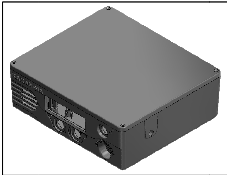
Figura 4.2 Vista isométrica del Gabinete
