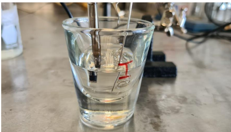
Figura 3.3. Celda electroquímica para curva de calibración.
