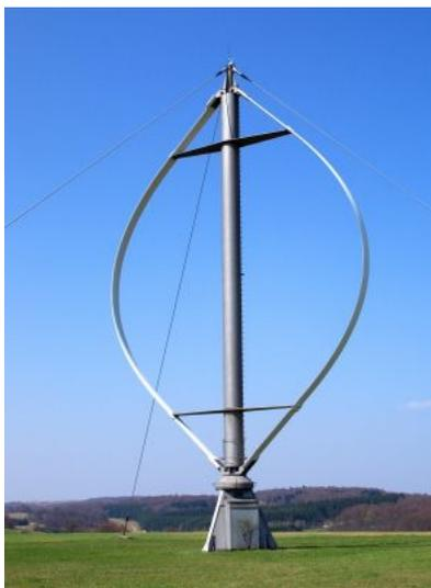
Fig. 2.2. Turbina de eje vertical, tipo Darrieus
