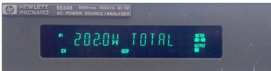
Fig. 4.22. Potencia trifásica de fuente.
