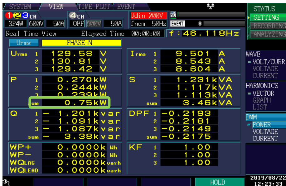
Fig. 4.18. Captura de pantalla de analizador de energía a la salida del generador con demanda de 75 W. (Corriente y potencia escaladas 10 veces la medida real).
