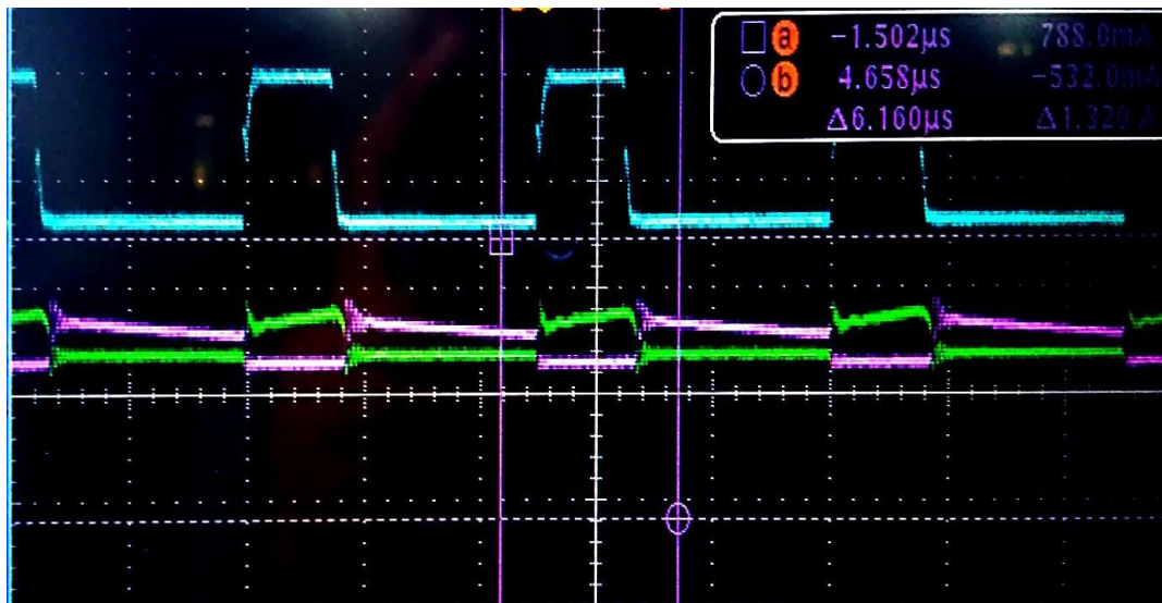
Fig. 2.9. Corriente de diodo y transistor modo reductor (C2M0080120D).
