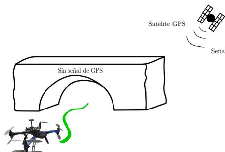
Figura 1.2: Debajo de puentes hay pérdida de señal de GPS.
