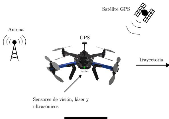
Figura 1.1: Navegación de los vehículos aéreos no tripulados.
