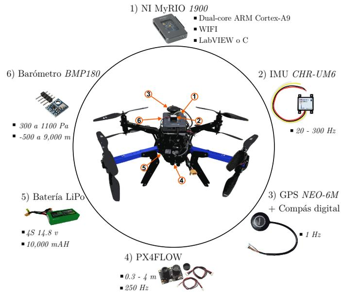
Figura 5.17: Prototipo del sistema de navegación INS/GPS/OF sobre el octorotor *X8-M 3DR*.
