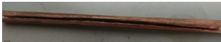
Figura 4.21: Tubo de cobre empleado para enrollar la bobina de lanzamiento del acelerador de reluctancia.
