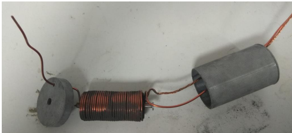
Figura 4.18: Bobina de lanzamiento y su cubierta plástica reutilizable lista para ser acomodada y rellena con material ferromagnético.
