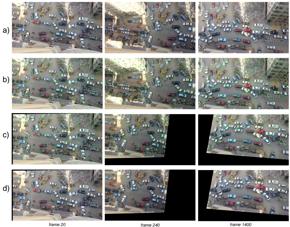
Figura 46. Aplicación de estabilización del video 1. a) Frames del video original. b) Puntos característicos para estabilización en video original. c) Puntos característicos proyectados mediante la homografía. d) Imagen estabilizada resultante.
