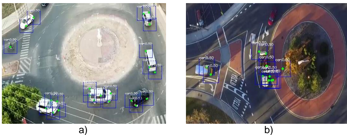
Figura 43. Detección de vehículos por el método Shi-Tomasi .
