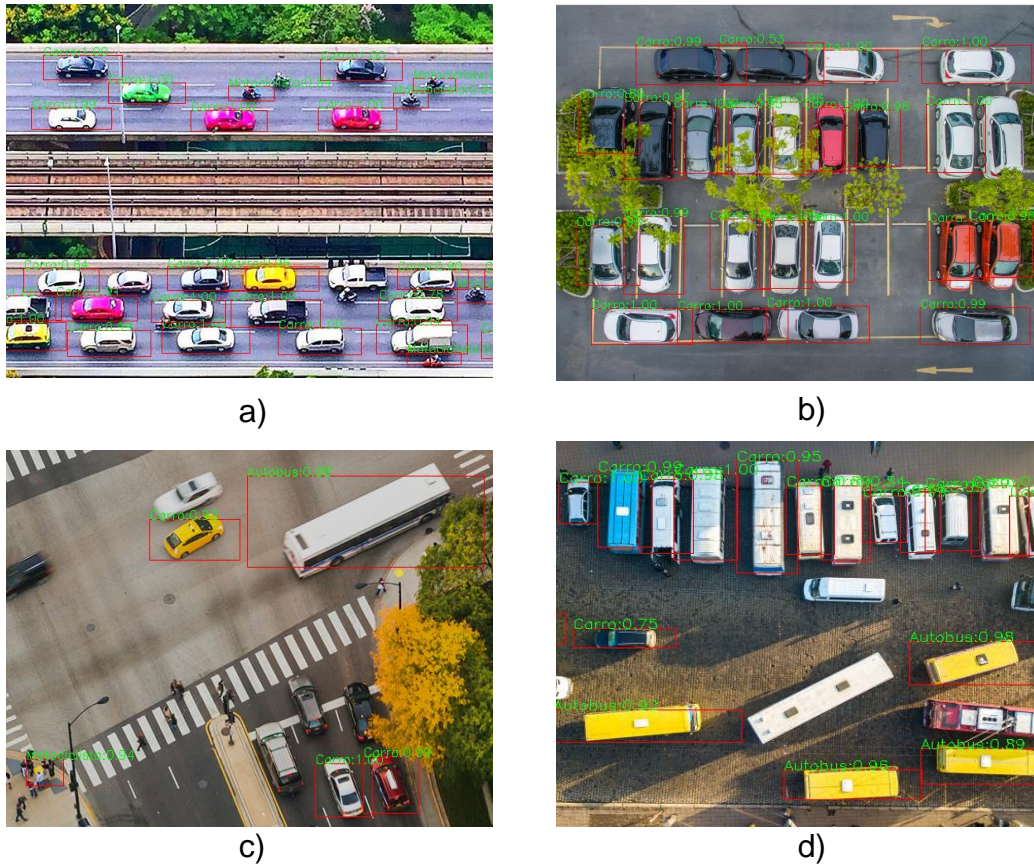
Figura 44. Aplicación de pesos candidatos de YOLO para su implementación en el proyecto.
