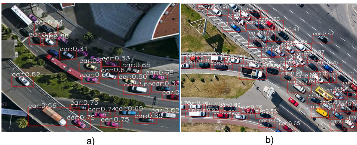
Figura 27. Aplicación de clasificación utilizando YOLO.
