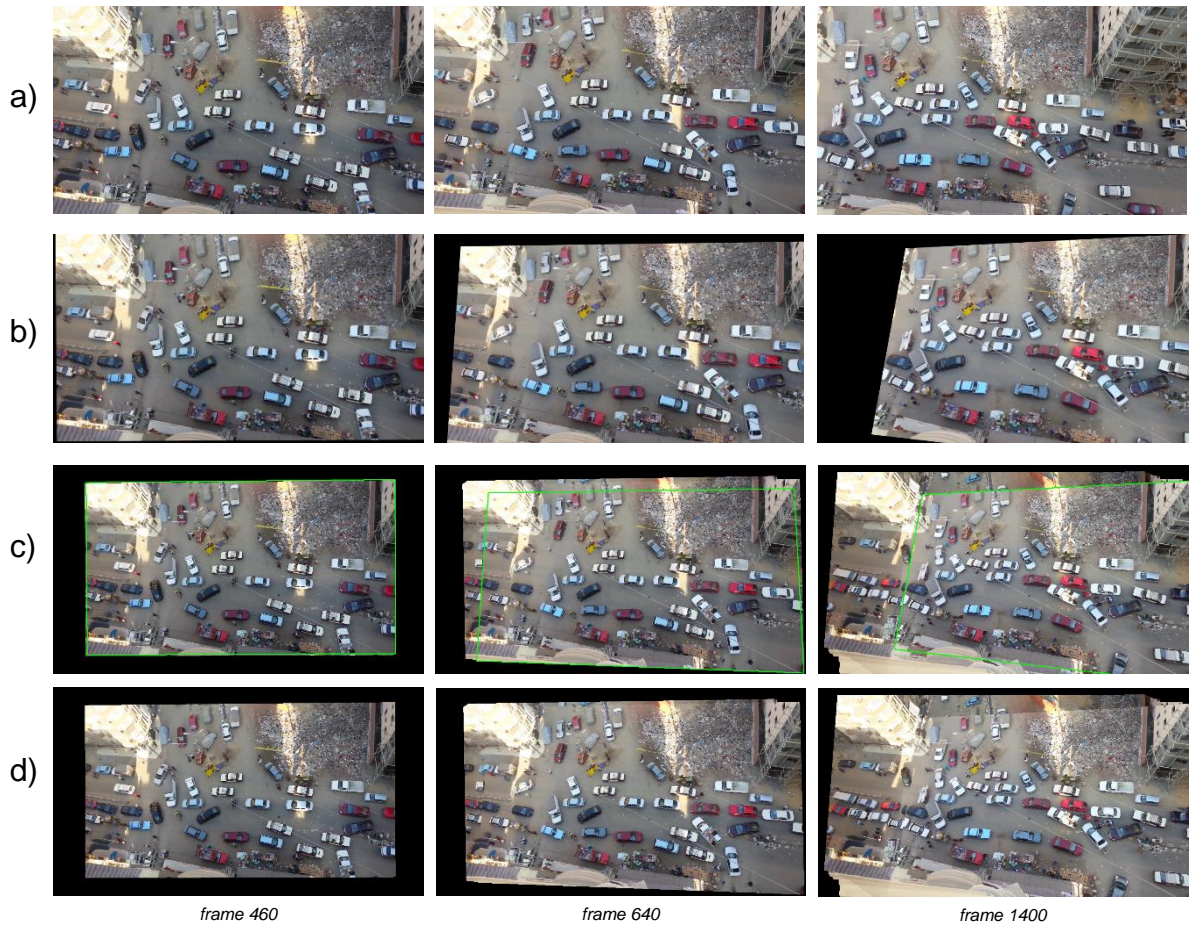
Figura 49. Video 1, aplicación de construcción de panorama. a) Frames del video original. b) Estabilización del video original. c) Región que ocupa la imagen estabilizada en el panorama. d) Imagen resultante o panorama.
