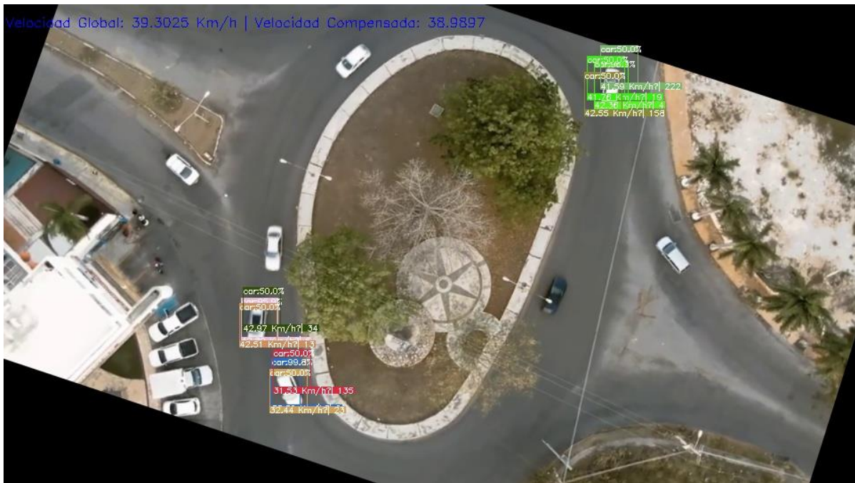
Figura 56. Frame 172. Calculo de velocidades implementando estabilización, Shi-Tomasi y YOLO.
