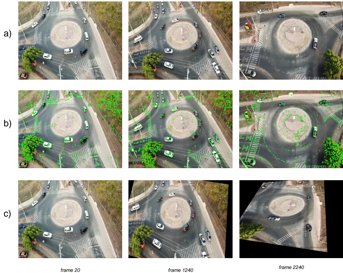
Figura 48. Aplicación de estabilización del video “glorieta_hacienda.mp4”. a) Frames del video original. b) Puntos característicos para estabilización en video original. c) Imagen estabilizada resultante.
