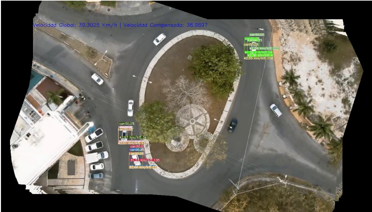
Figura 57. Frame 172, cálculo de velocidades implementando clasificación, estabilización y panorama.
