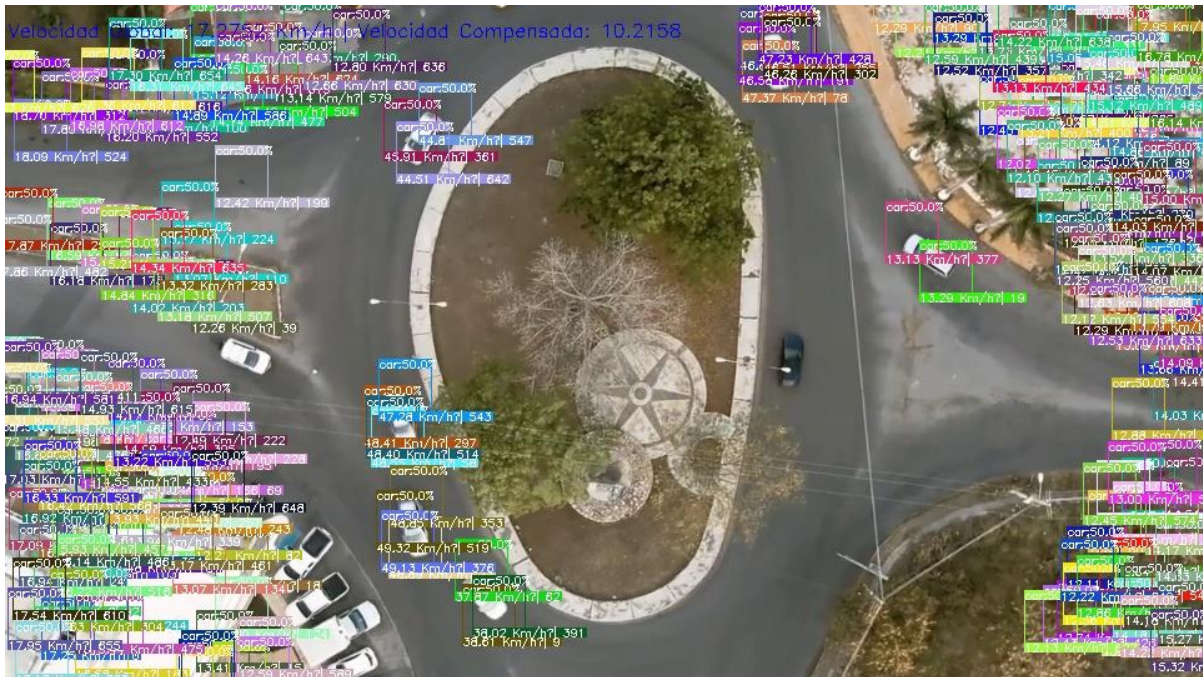
Figura 53. Muestra la aplicación de la estimación de velocidad, tomando los puntos característicos calculados mediante el método Shi-Tomasi al frame 172.
