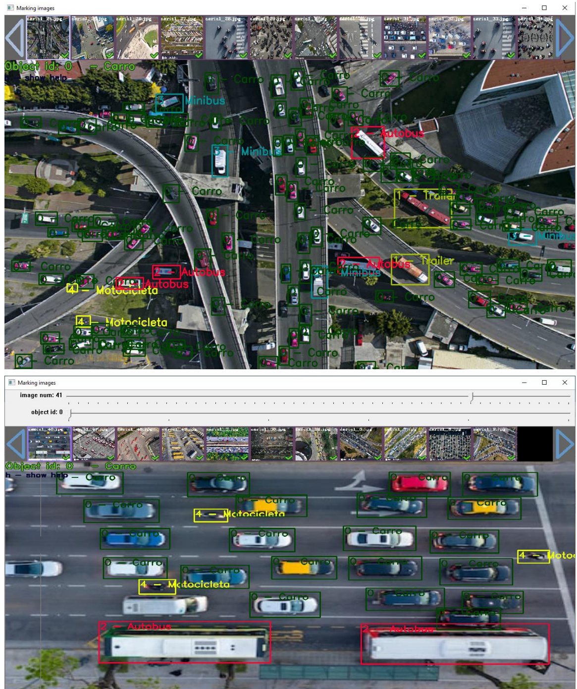
Figura 28. Configuración de base de datos de imágenes por Yolo-Mark.
