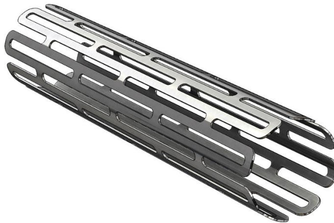
Figura 45. Propuesta CAD del diseño del stent intracoronario.
