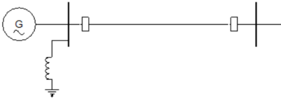
Figura 2.2.- Reactor eléctrico de potencia conectado al bus de la subestación.
