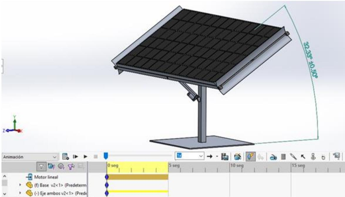
Figura 5.7. Estado inicial del análisis de movimiento del actuador lineal sobre el seguidor. El ángulo de inclinación del panel es de 32.23°.
