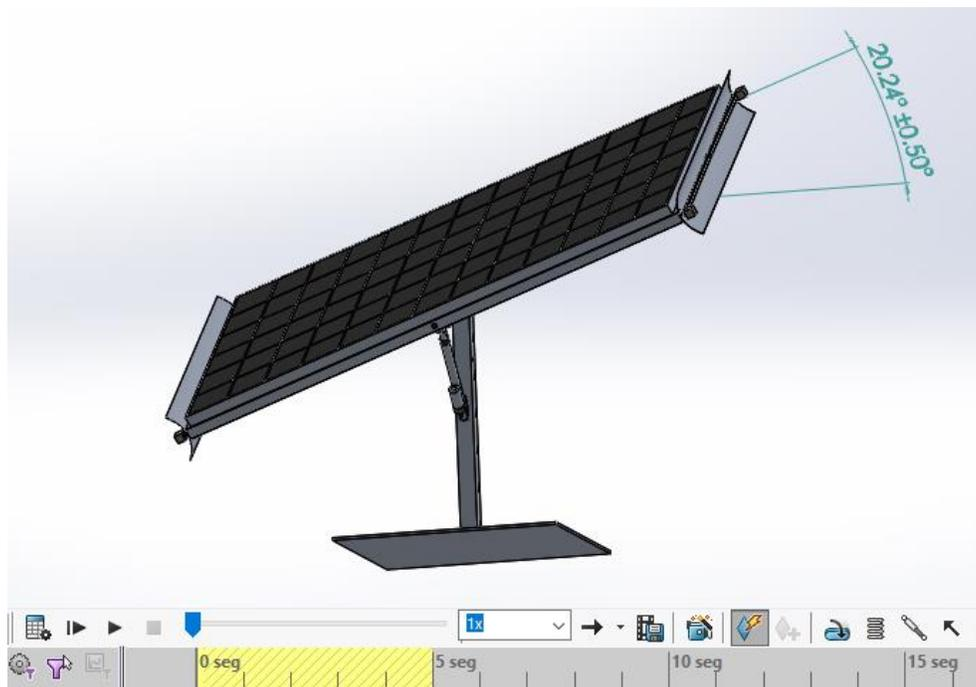
Figura 5.9. Estado inicial del análisis de movimiento azimutal por gravedad.
